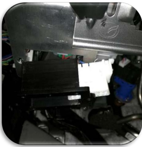
OBD-Buchse durch die Öffnung des Halterahmens führen und in unteres OBD-Saver Gehäuse einschieben
