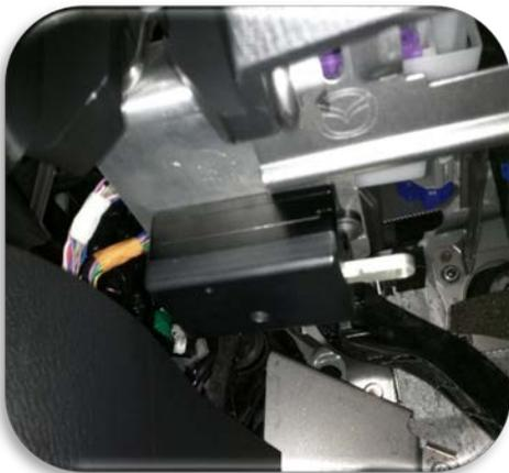
Schlossteil des OBD-Saver aufstecken und mit 3xM3 Schrauben verschrauben. Schlossteil schließen und Schlüssel entfernen.
