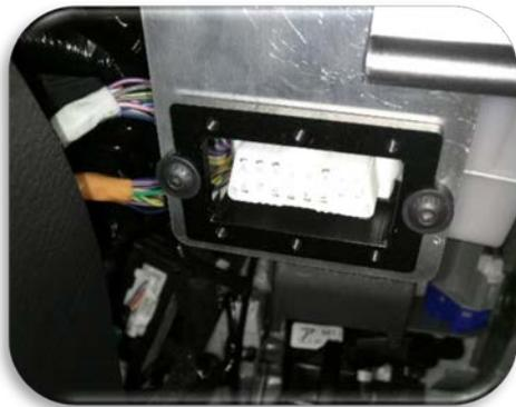
OBD-Saver Gehäuse inkl. OBD-Buchse mit Halterahmen verschrauben (Linsenschrauben)
